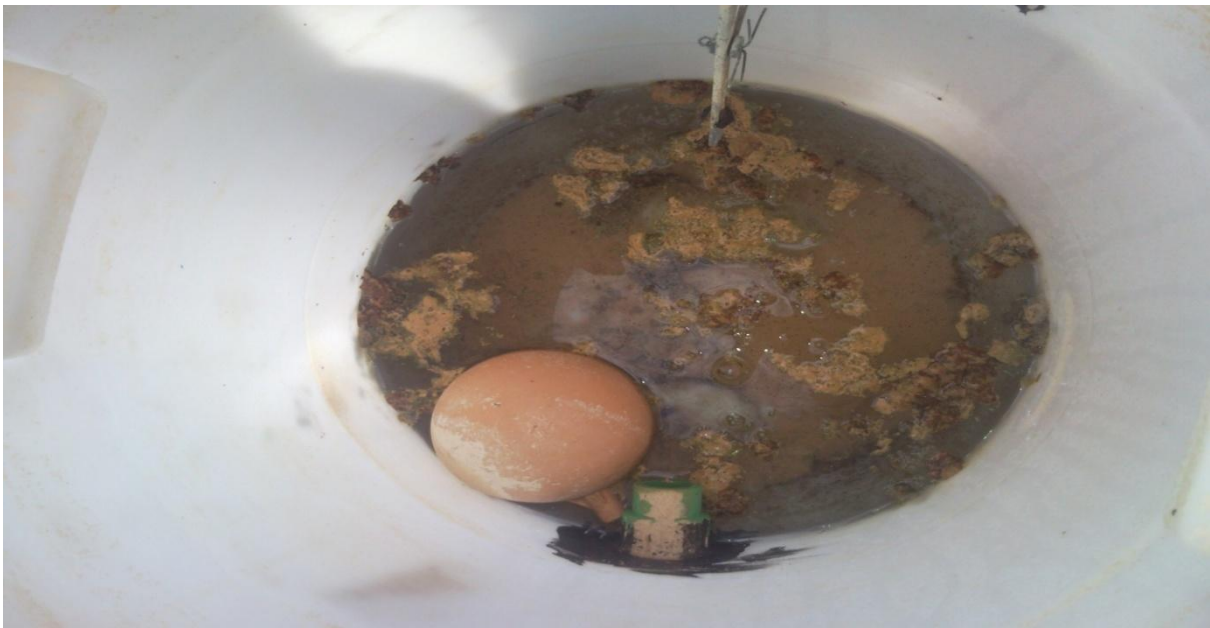
Photo n°8 : Floccs de ferromanganèse
