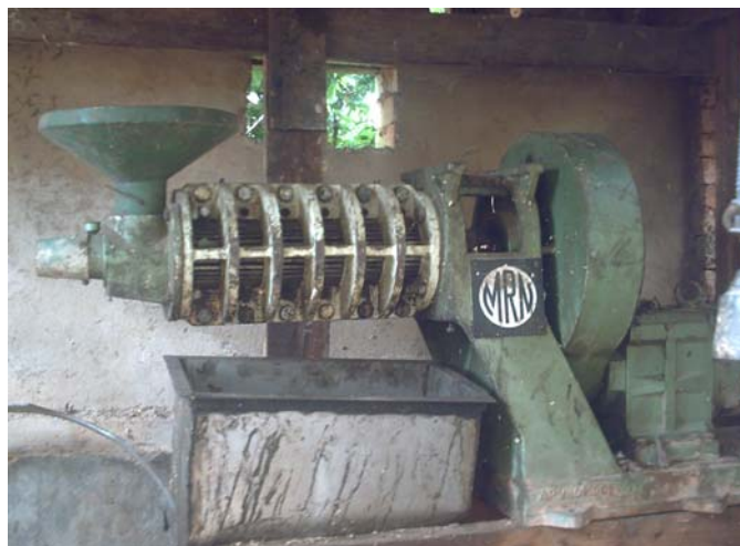
Photo 5 : Vue de la presse mécanique utilisée
