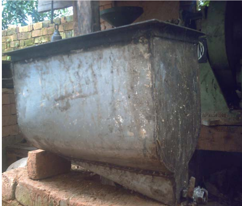
Photo 6 : Cuve de collecte de l'huile
