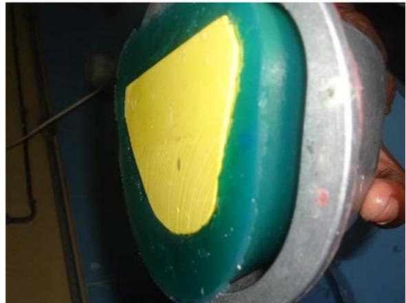
*Figure 18: Coulée de gélatine dans le moufle    Figure 19: Sortie du modèle de la gélatine*
