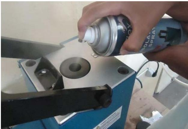
Figure 55 : Lubrification de l'orifice d'injection
