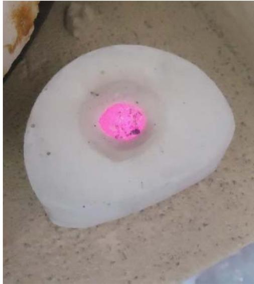
*Figure 35: Refroidissement du métal dans le cylindre*
