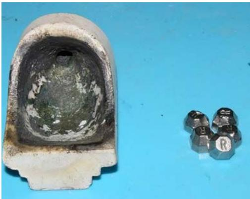
*Figure 33 : Préparation de la creusé (nettoyage)*
