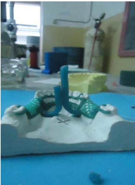
Figure 24: Positionnement des tiges de coulée
