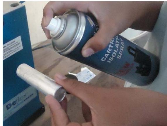
Figure 56 : Lubrification de la canule
