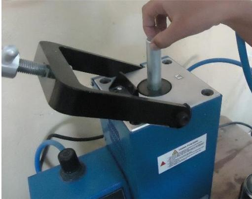
*Figure 57: Insertion de la canule*
