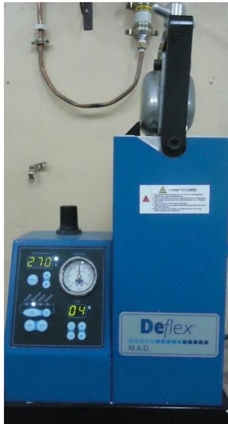
*Figure 59: Injection de la résine flexible à 270°C*
