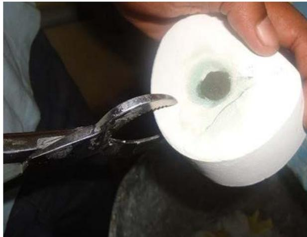
*Figure 36 : Décoffrage du stellite du cylindre*
