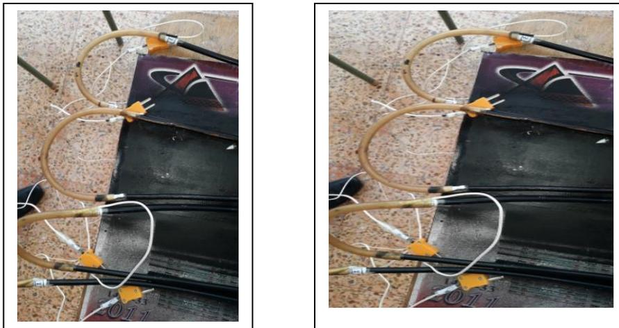
Fig3.21 : Emplacement des thermocouples dans l'installation
