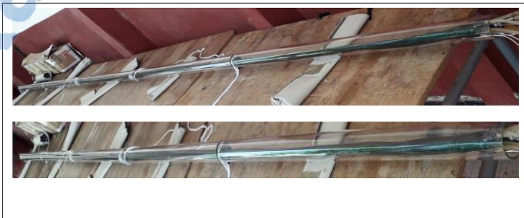
*Fig3.5 : Le jeu annulaire entre le tube en cuivre et le verre.*
