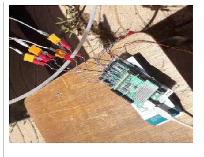
Fig3.19 : Chaîne acquisition Arduino
