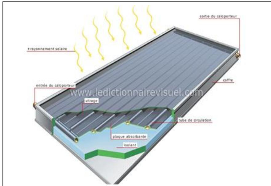
Fig1.10 : Un capteur thermique plan vitré
