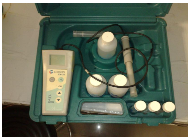
Figure IV.2 : Photo du conductimètre portable CM 35
