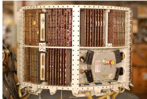
Figure 1 : Illustration de l'Autonetics-D17, l'ordinateur de guidage
