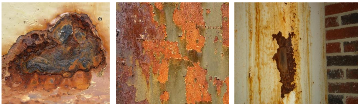
Figure 14: Différentes corruptions de l'acier et du fer exposés à l'eau et l'air.
