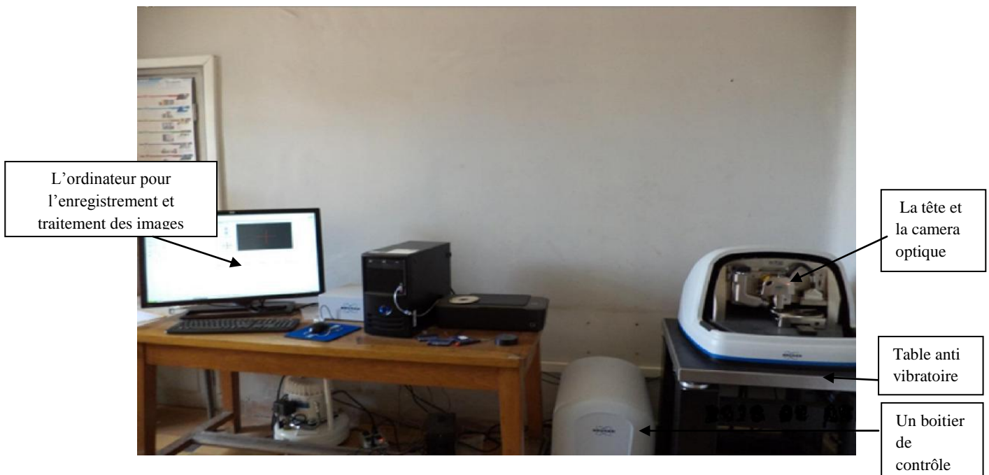
Figure.III.9. Les différents éléments composant l'AFM du laboratoire.
