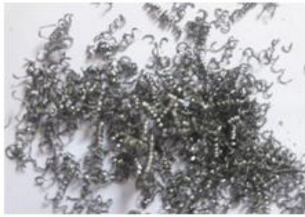
(j) : V_c = 70\text{m/min} p = 0.5\text{mm} a = 0.2\text{mm/tr}
