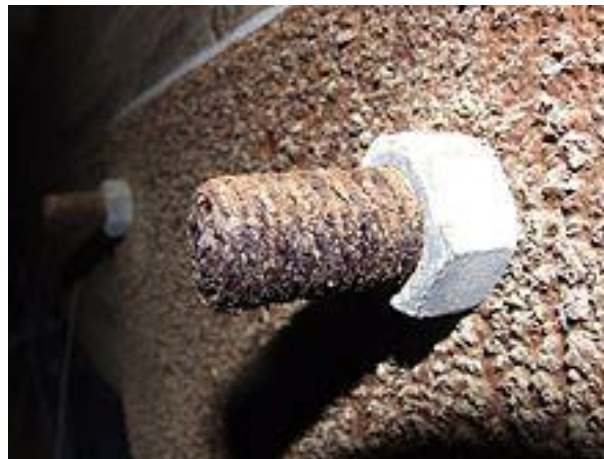
Figure I.3 : Image représentant un processus de corrosion galvanique (la vis est dans un état avancé de détérioration alors que l'écrou ne semble pas être affecté par la corrosion) [5]
