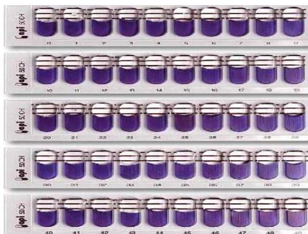
FIGURE 3.3: La galerie API 50 CHL avant l'ensemencement .
