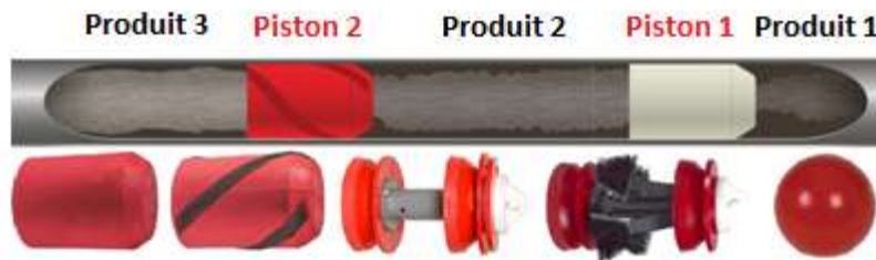
Fig. 2. 1 Ecoulement multiproduit avec des séparateurs (Pistons racleurs)
