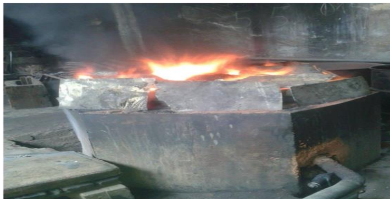
Fente des chutes de laiton
