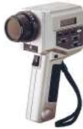
**Figure 1-1: Mesurer la lumière avec un luminance mètre**
