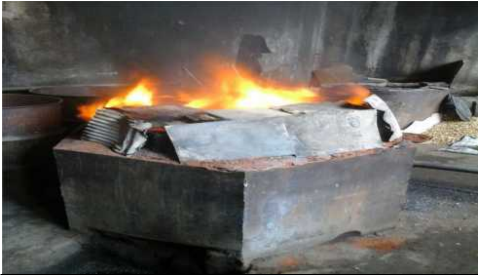
Photo 8 : Four de fendage des chutes de laiton.
