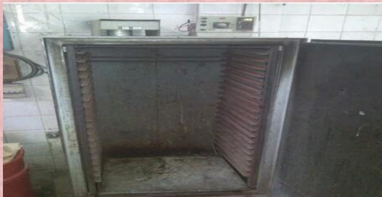
Image 19: machine de séchage à air chaud
