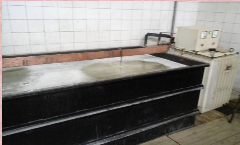
Image 13: Bain de dégraissage
