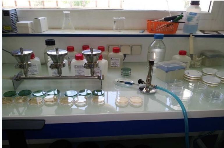
Figure 3 : Photo de la méthode filtration sur membrane
