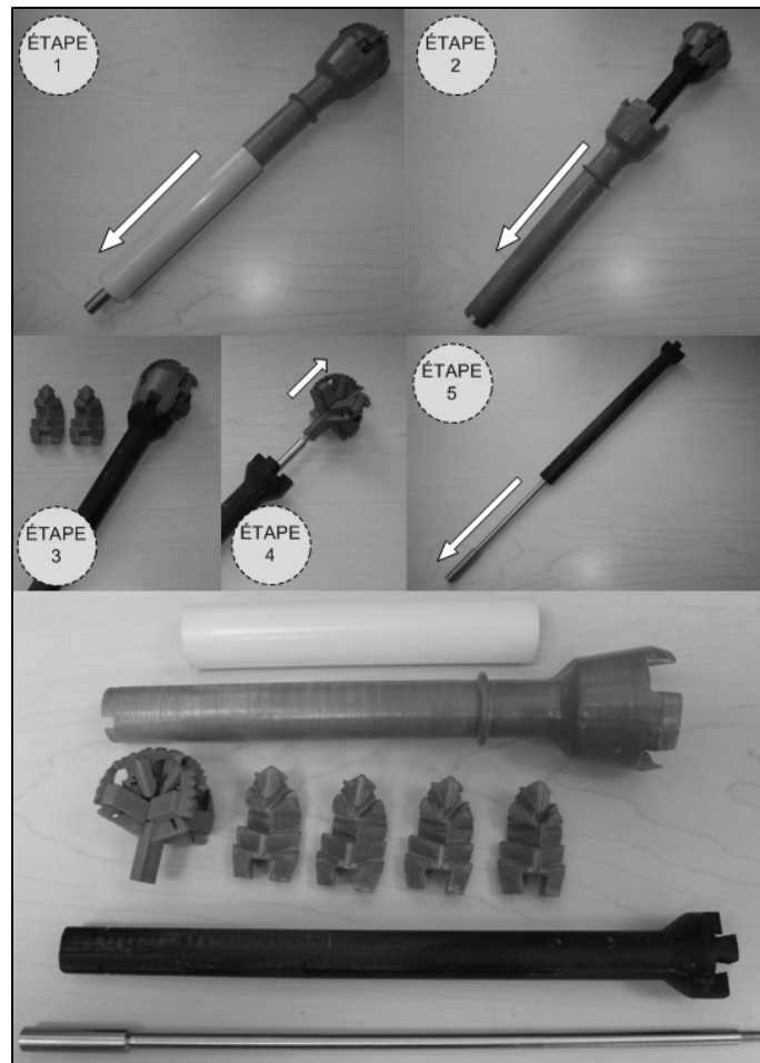
Figure 4.6 Étapes de désassemblage de la partie inférieure
