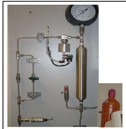
Figure 2.6 Système de pressurisation
