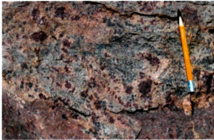
Figure 2.2: Grenat avec couronne felsique dans une granulite peltique
