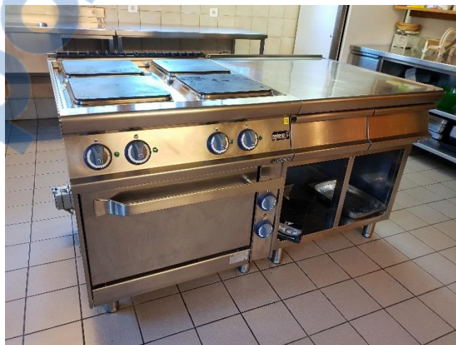
Figure 12 : Bloc fourneau GICO – cuisine « Cordée »
