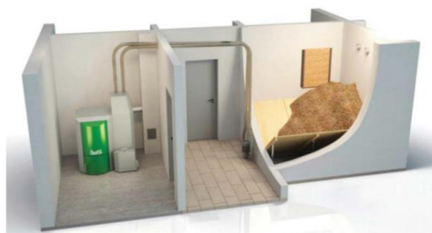
Figure 26 : Illustration d'une chaudière à pellets équipée d'un silo à plancher incliné
