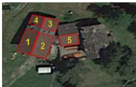
Figure 42 : Superficie corrigée pour la pose des panneaux solaires
