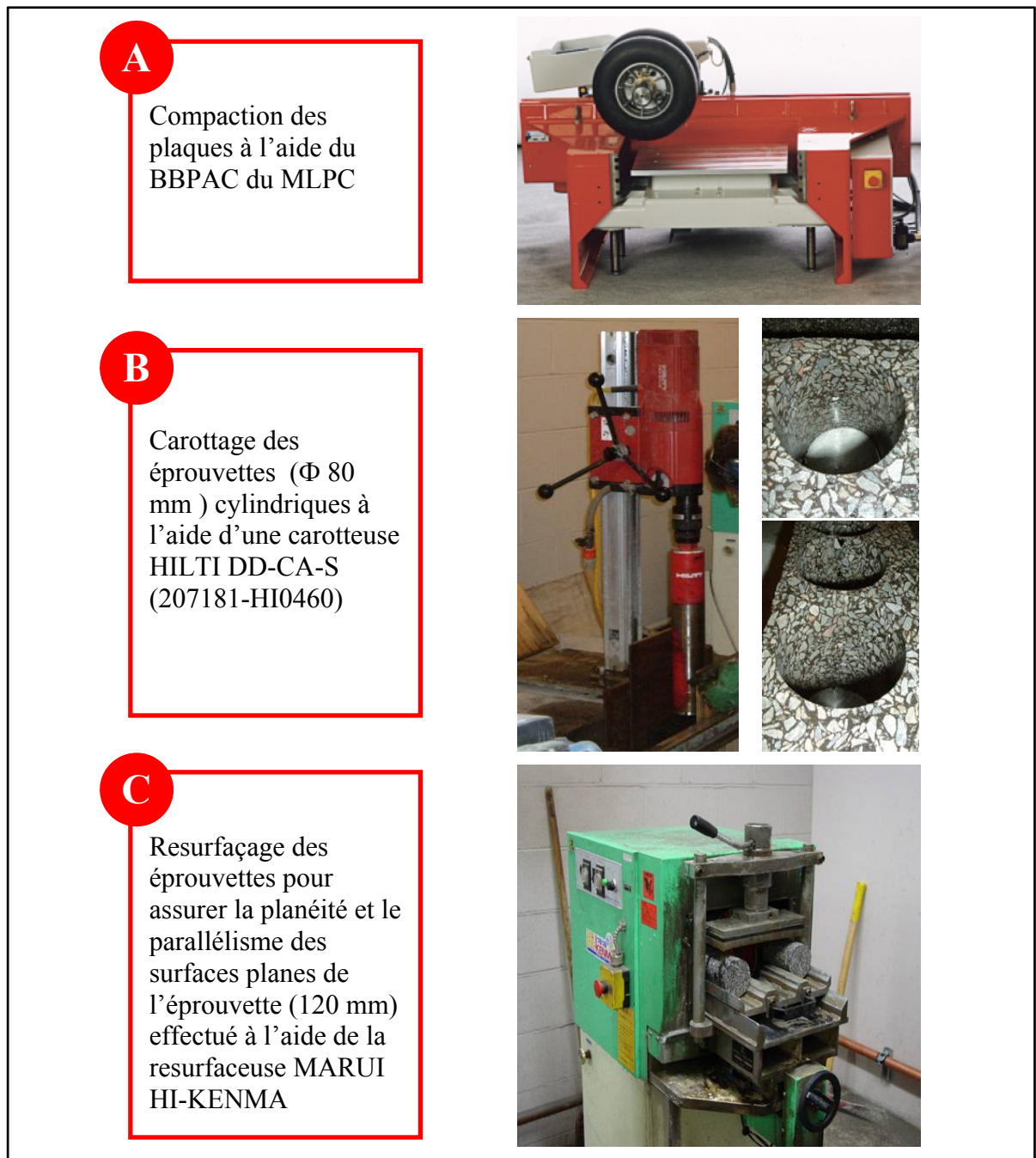
Figure-A XV-1 Types et fonctions des équipements utilisés lors de la confection des éprouvettes cylindriques
