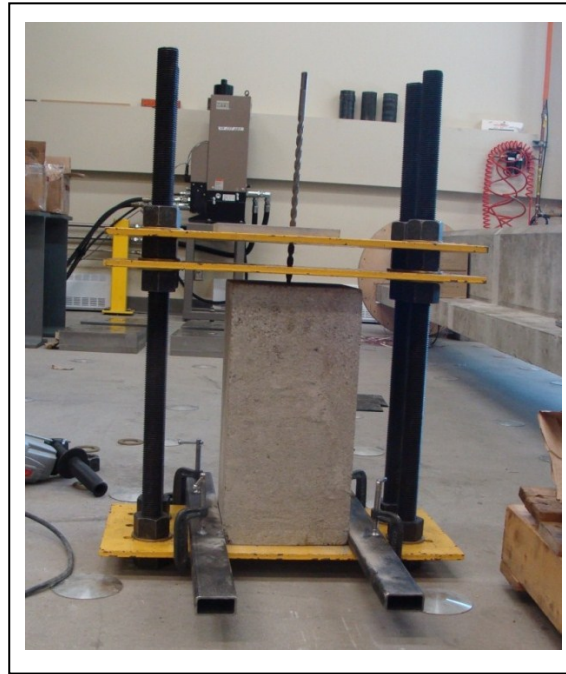
Figure-A I-1 Système d'alignement de la mèche avec l'axe Vertical du bloc en béton
