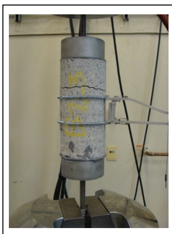
Figure 4.5 Essai de traction sur le béton
