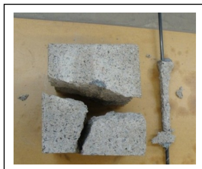
Figure 5.9 Rupture sur l'interface béton/époxy
