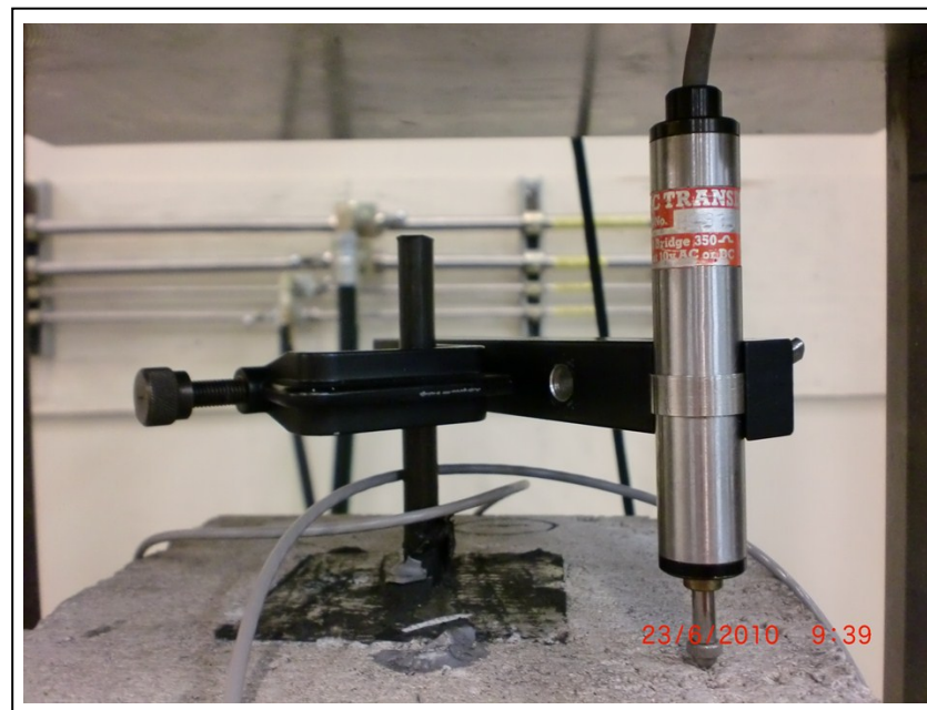
Figure-A I-4 Capteur de déplacement de la tige en CFRP par rapport au bloc de béton
