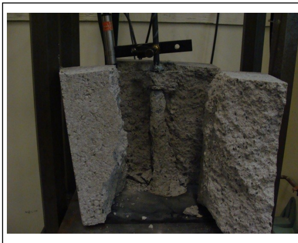
Figure 5.1 Rupture par éclatement du béton
