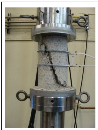
Figure 4.4 Essai de compression sur le béton
