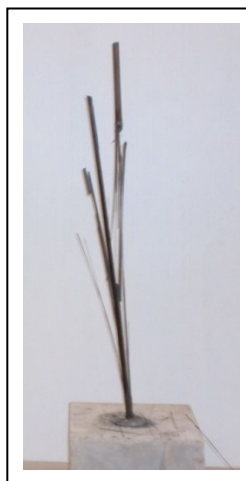
Figure 5.6 Rupture de la barre en CFRP
