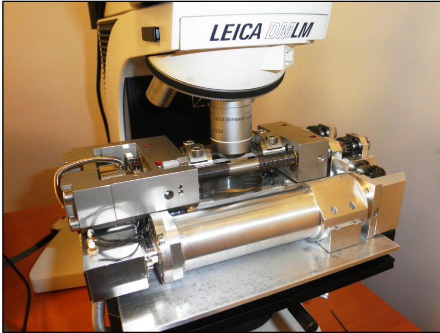
Figure 2.14 Photo du montage du banc d'essai de traction sous microscope Prise au laboratoire de caractérisation mécanique de l'ETS
