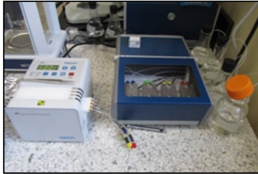
Figure 2.3 Photo du montage de QCM-D du LBeV Tirée du site officiel du LBeV
