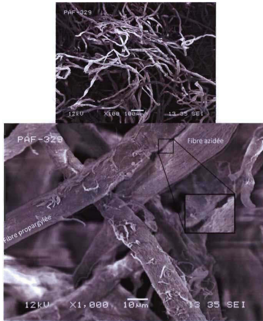
Figure 2.3.a : Clichés MEB des fibres celluloses après réticulation (X 100 en haut et X 1000 en bas).
