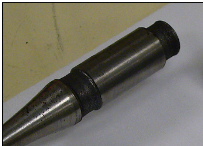
Figure 6.11 Éprouvette usée, acier O1, après 4.3 millions de cycles
