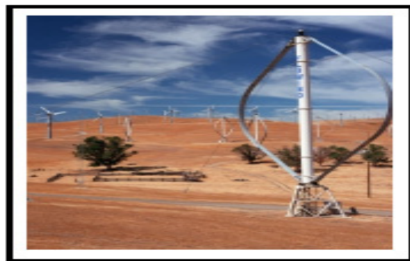
Figure 1.16 Turbine à axe vertical Tirée d'EDILEC (2012)
