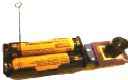
Figure 2.11 : Un capteur d'image ALOHA attachée à un mote Mica2 [20]
