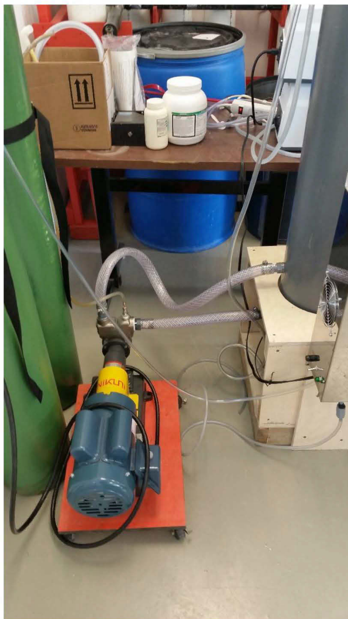
Figure 6.12 : Première configuration de la pompe à microbulles avec la colonne
