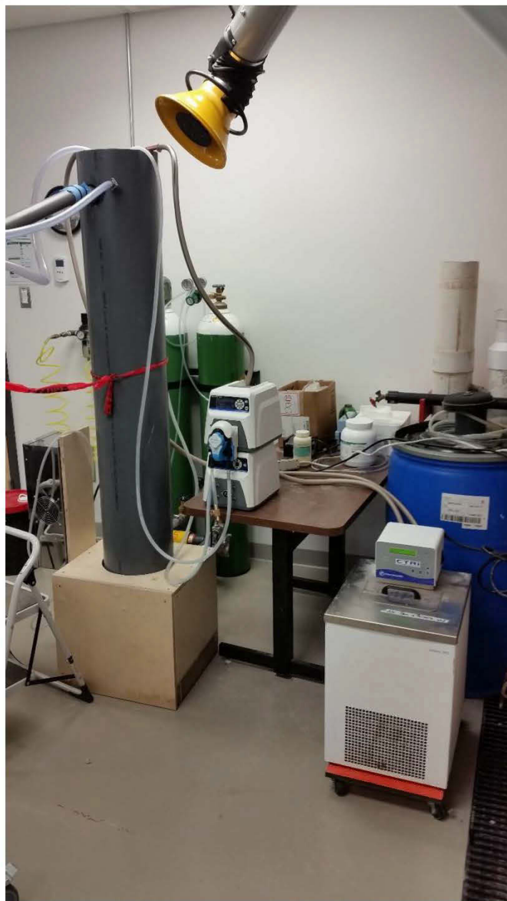
Figure 6.13 : Configuration d'un essai réalisé avec un refroidisseur au glycol et la colonne
