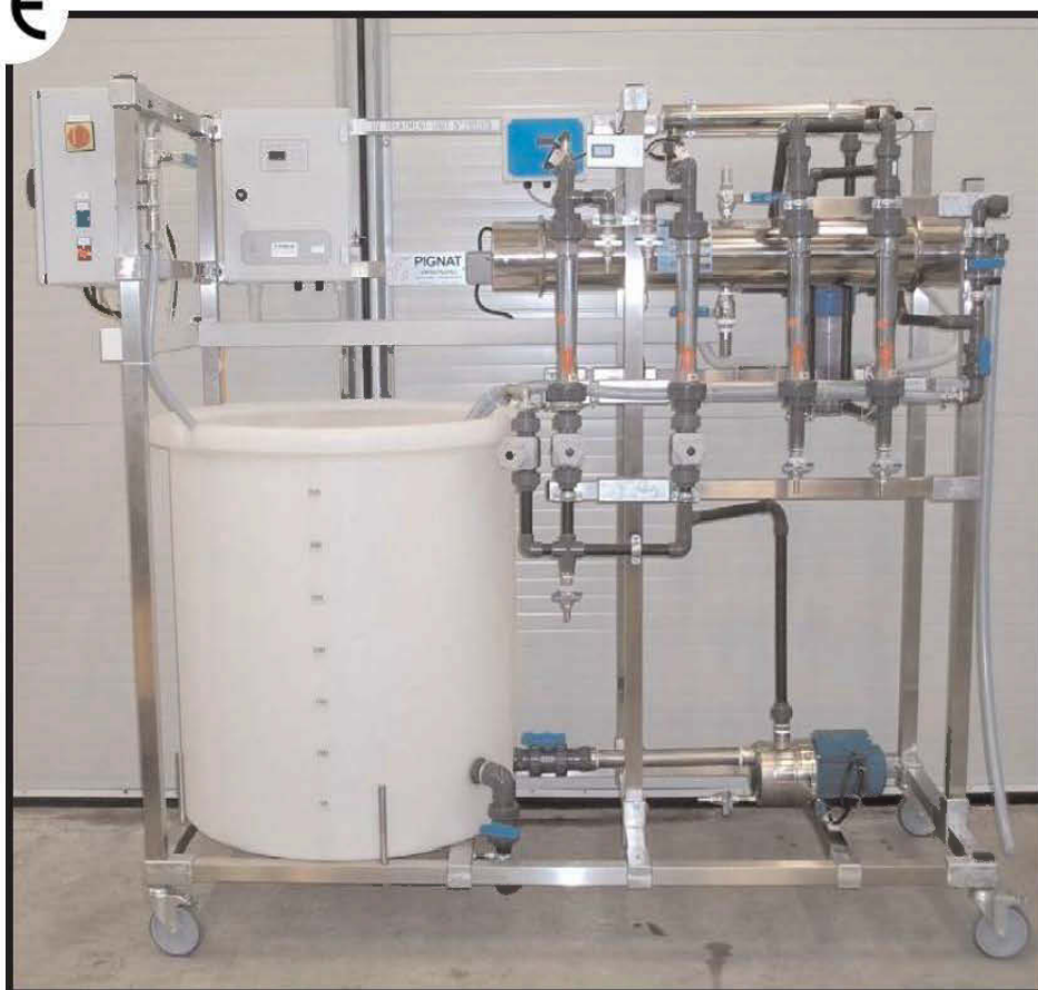
Figure 6.5 : Unité pilote de désinfection par UV (tirée de la fiche fournie par le fournisseur)
