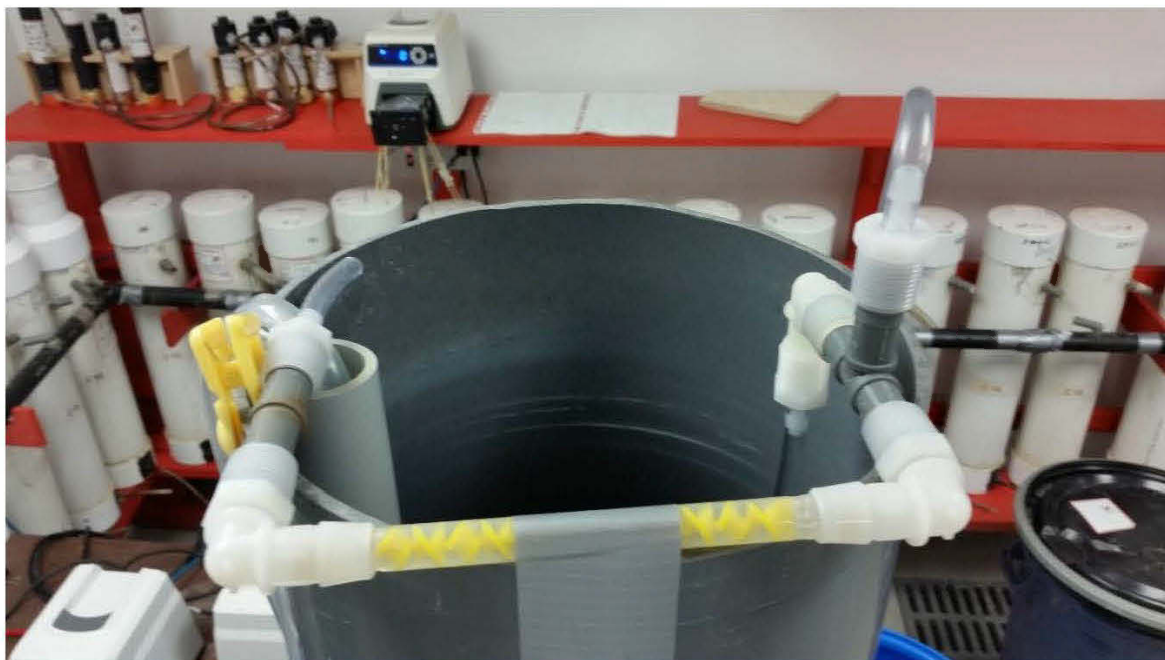
Figure 6.9 : Configuration d'un essai avec mélangeur statique pour injection de H_2O_2
