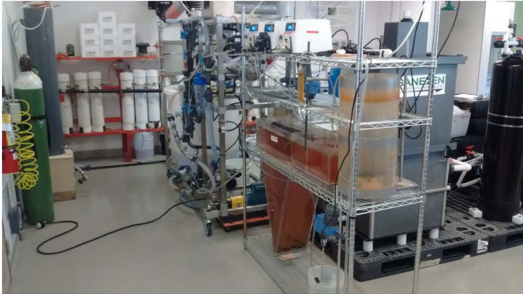
Figure 4.26 : Système de traitement complet utilisé lors de l'essai en continu avec l'effluent I
