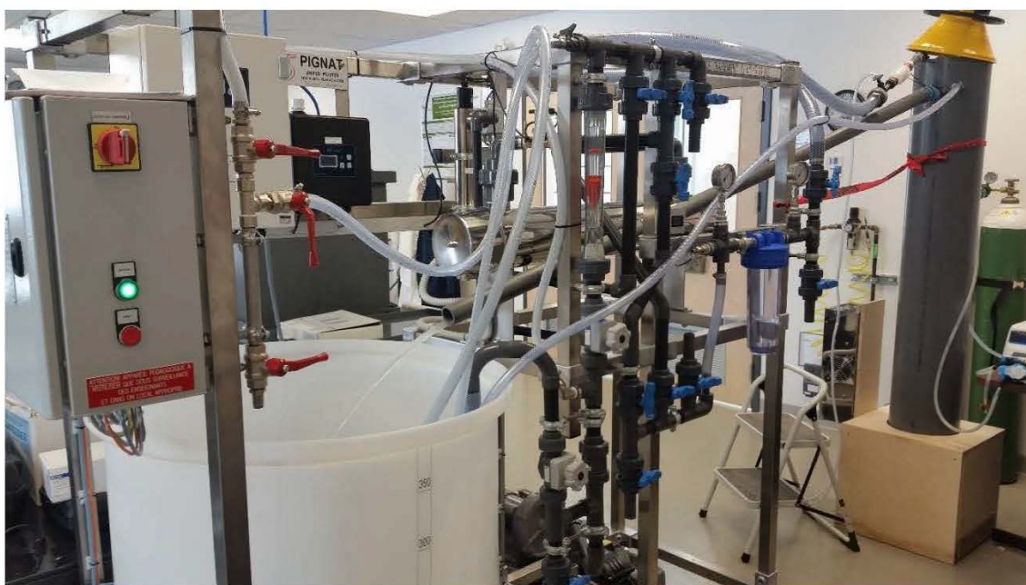
Figure 6.10 : Configuration d'un essai combinant la colonne et l'unité pilote UV pour injection d' O_3 avec un venturi en passant par un flash reactor
