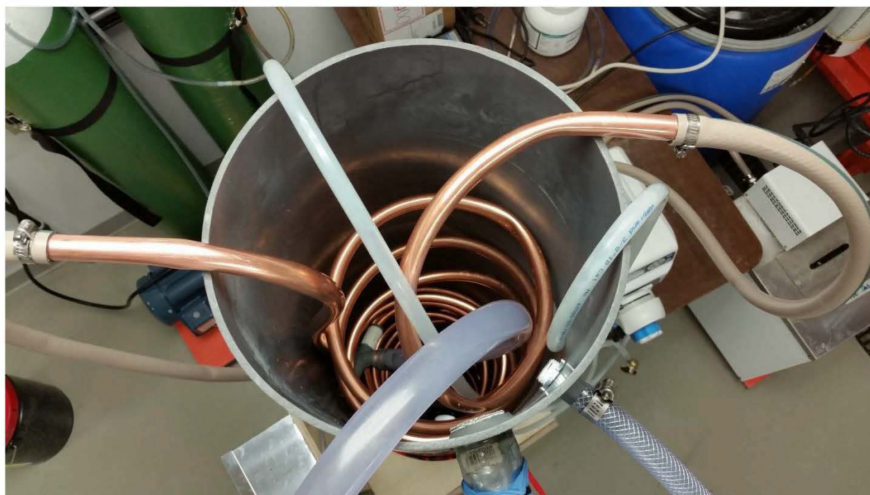
Figure 6.15 : Fabrication maison d'une bobine de refroidissement avec un tuyau de cuivre
