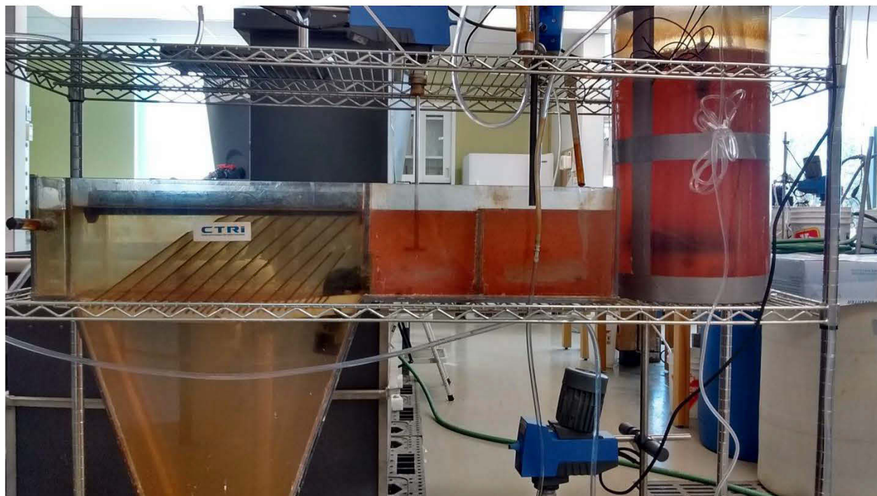
Figure 6.29 : Décanteur, réservoir de coagulation-floculation et colonne d'aération
