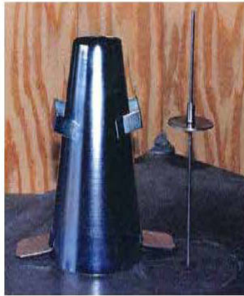
Figure 1-7 : Test d'affaissement au cône modifié pour la mesure de la vitesse de chute (Ferraris et de Larrard, 1998)
