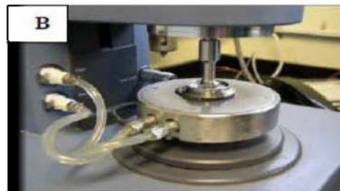
Figure 1-8 : les différentes étapes de l'essai avec le disque parallèle du rhéomètre AR 2000 ; A-Mise en place de l'échantillon et B- Début des mesures (Ouattara.,2011)
