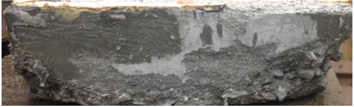
c) Figure 5.18 : Aspect des éprouvettes à la fin de l'essai d'écaillage pour le mélange a) FS10 b) PV20FS10 avec le scellement et c) PV20FS10 après le retrait du scellement
