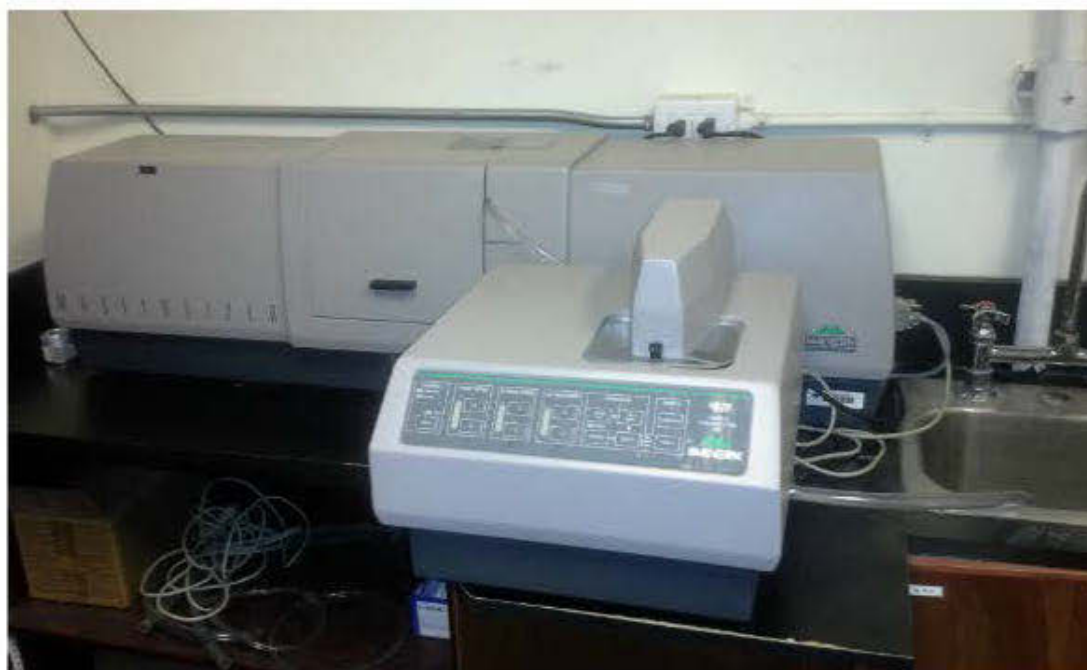
Figure 3-13: Granulomètre au laser Mastersize 2000 de Malvern
