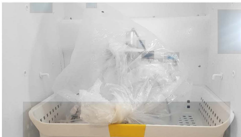
Figure 3-14: Cellule remplie d'azote dans un sac en plastique transparent rempli d'azote le tout placé au congélateur à -12^{\circ}\text{C}
