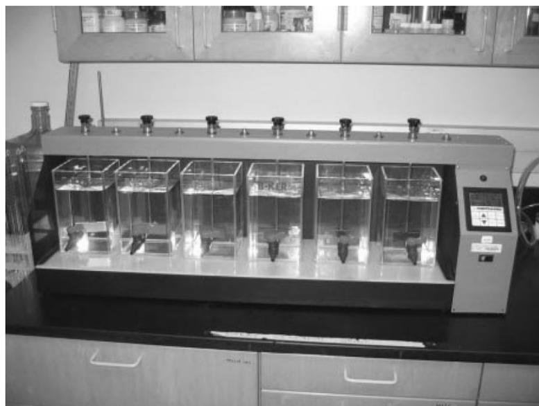
**Figure 80: Rampe de jar test en laboratoire**
