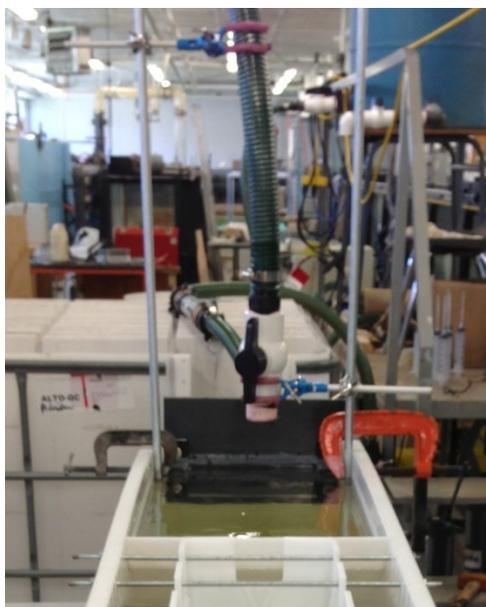
Figure 47: Dispositif de vidange de la solution de traceur
