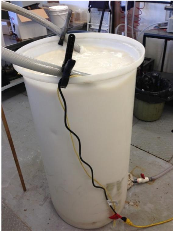
Figure 27: Réservoir contenant la suspension de Kaolin
