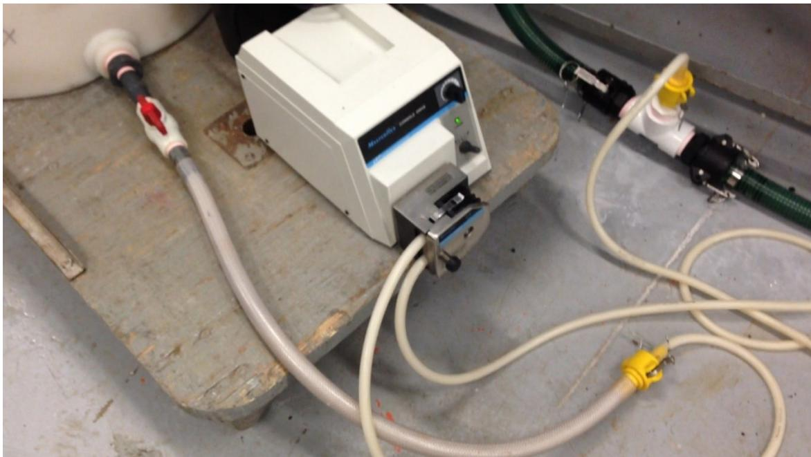
Figure 28: Pompage de la suspension de Kaolin dans l'eau brute
