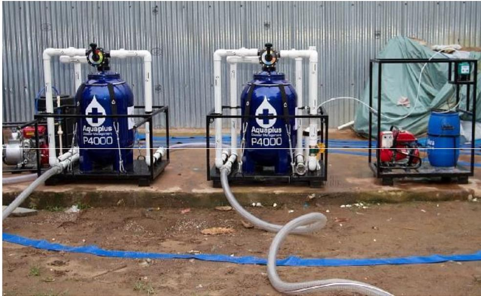
Figure 5: Système de filtration granulaire à deux étapes (P4000 CL Operation and Maintenance manual, 2010)
