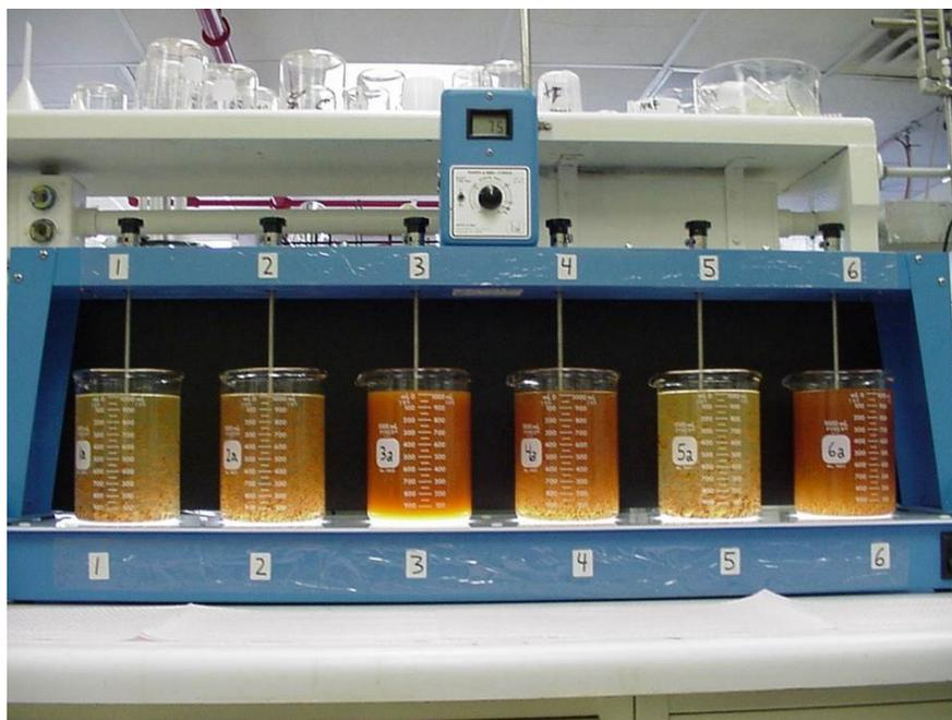
Figure 17: Rampe de jar test (image provenant de CHEM-SULT, INC.)<sup>3</sup>
