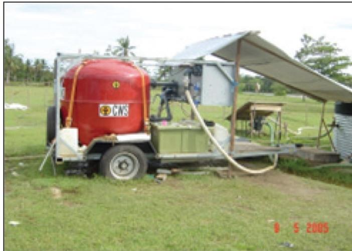
Figure 4: Système de filtration granulaire à tape unique (Clarke & Steele, 2010)
