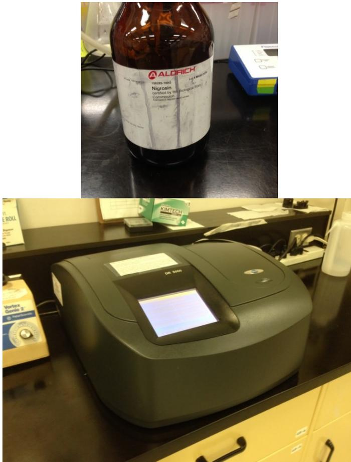
**Figure 48: Traceur (Negrosin) et spectrophotomètre (Hach DR-5000) utilisés pour les essais au traceur**
