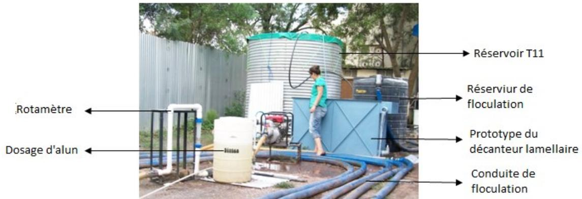
Figure 20: Montage de traitement (Bourgeault, 2011)
