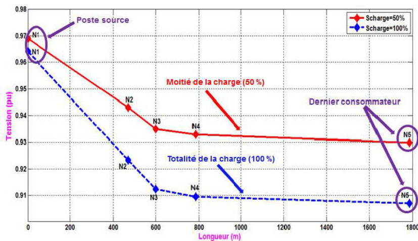
Figure 21 : Profil de tension pour deux régimes de charge sans présence de GER pour la zone 1
