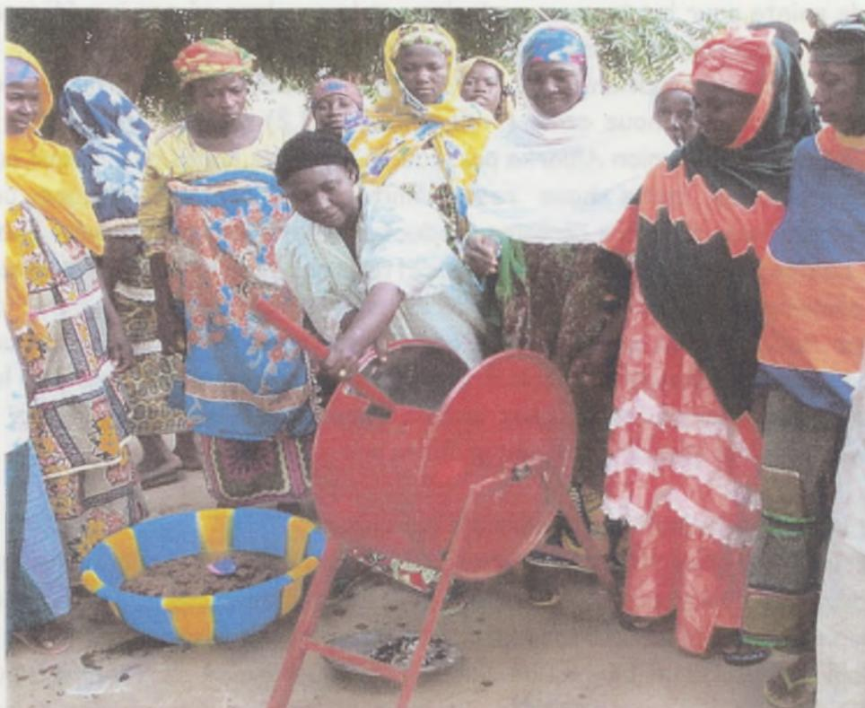
**Photo n°5** Extraction d'huile à l'aide d'une presse à huile manuelle
