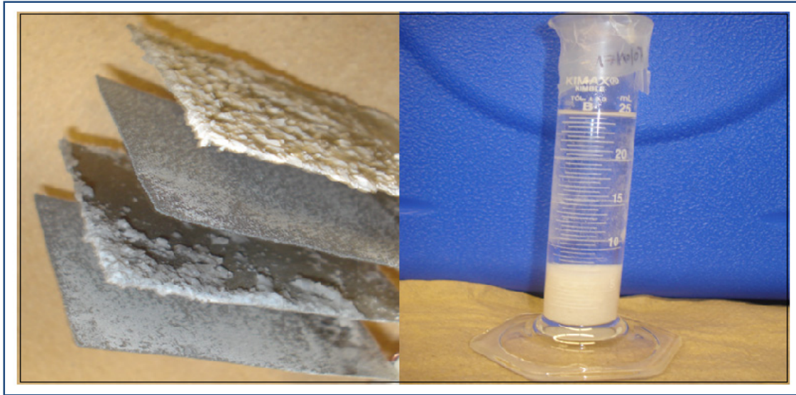
Figure 3.2 Oxydation des électrodes d'aluminium et dépôt blanc à la fin.
