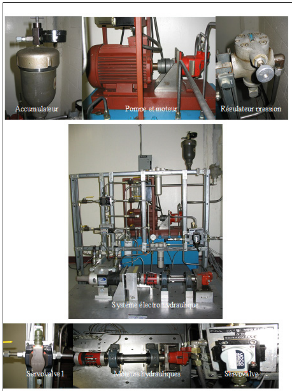
Figure 2.1 Composition du système électrohydraulique du LITP
