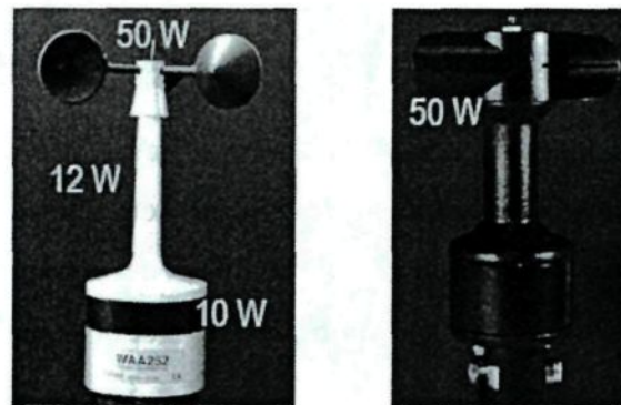
Figure 42. Anémomètres chauffés : à gauche, Vaisala; à droite, NRG
