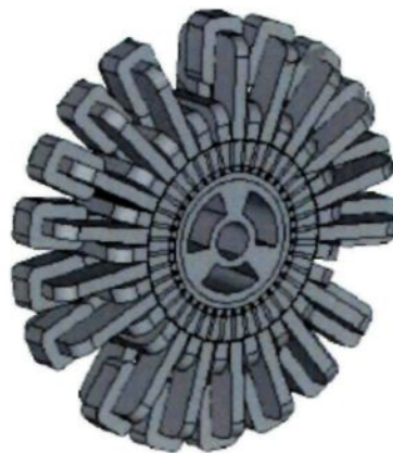
Figure 3-13 : Machine triphasée à flux transverse [CHE-2008]
