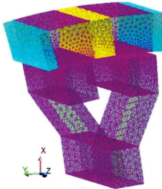
Figure 7-3 : Maillage des parties actives de la machine
