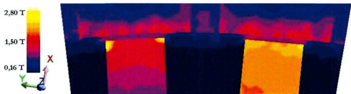
Figure 7-8 : Évolution du module de l'induction dans l'entrefer.
