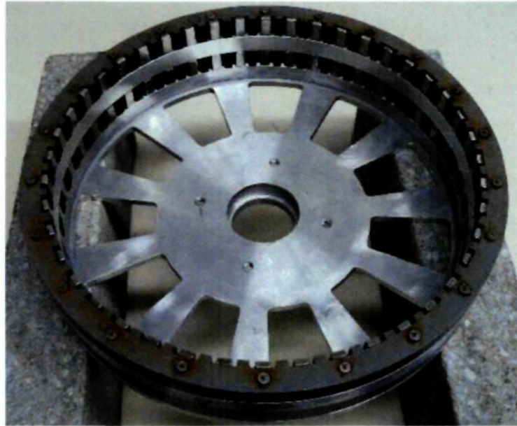
Figure 6-4 : Rotor du prototype de la machine à flux transverse
