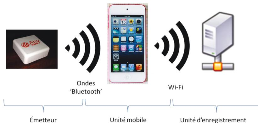
**Figure 6 : Schéma fonctionnel du système de positionnement AnyWARE**
