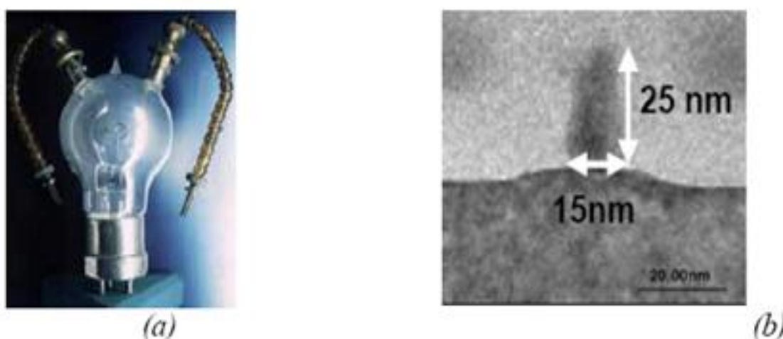
Figure I.1. Évolution de la technologie : de la lampe triode (a) au MOSFET nanométrique vue en microscopie électrique à transmission (b) [Bœu'01]
