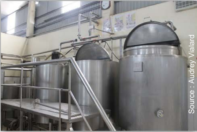
Figure 41 : cuves de mélange (standardisation en m.g, m.s, ajout de sucre, etc)
