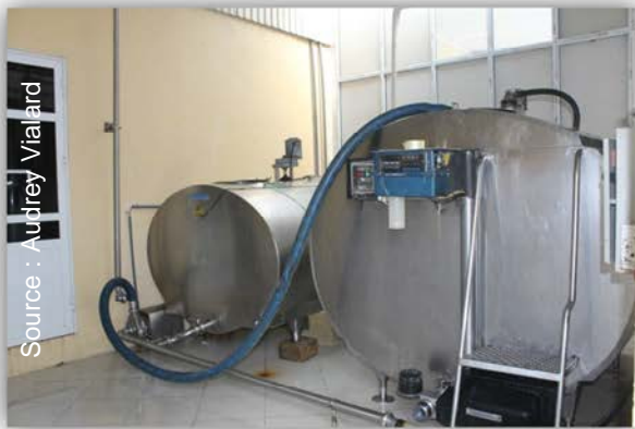
Figure 39 : tanks réfrigérés dans lesquels est stocké le lait (tanks de 2 et 3 tonnes)
