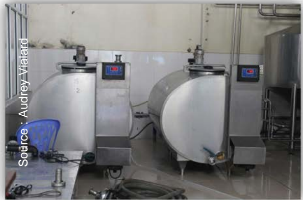
Figure 40 : tanks réfrigérés dans lesquels est stocké le lait
