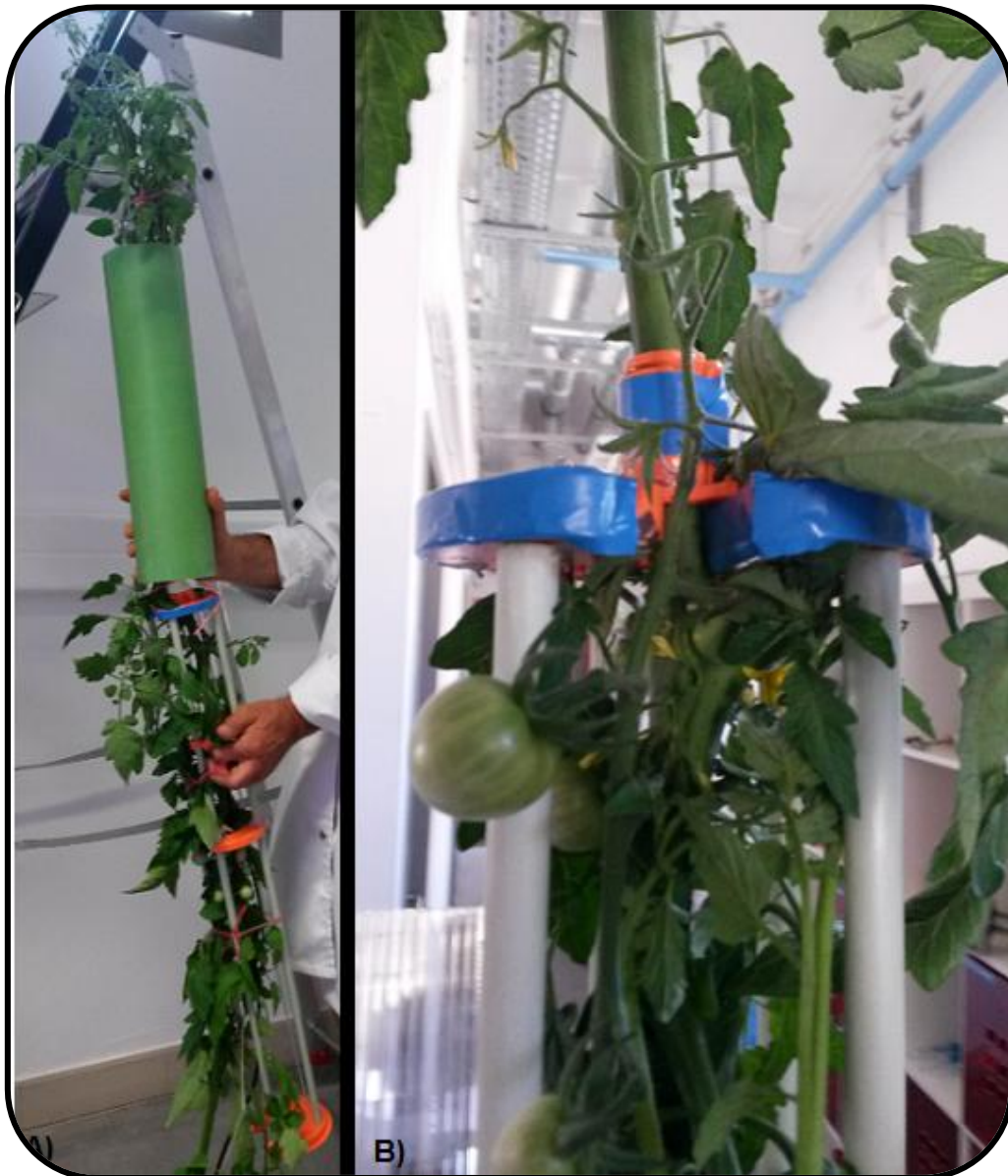
Figure 33 : Ajustement du support de l'antenne (A) et de l'antenne saddle coil clipsable (B) autour de la tige de tomate.
