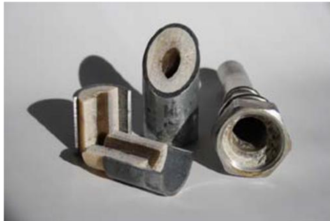
Figure 7: Dépôts de tartre dans des canalisations
