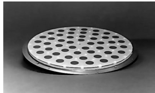
b. Réseaux conformes d'antennes
