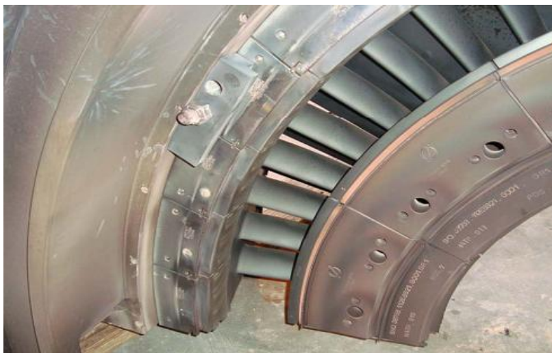
Fig. I.18 Distributeur et diaphragme de deuxième étage
