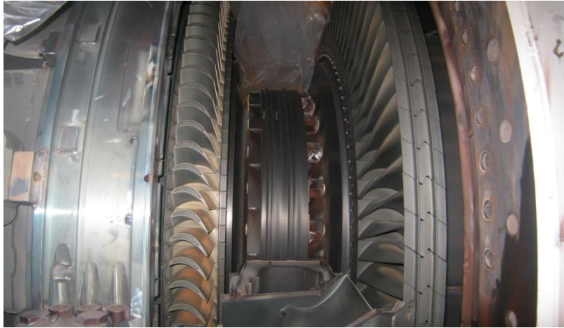
Fig. I.19 Ensemble rotor de la turbine
