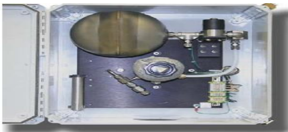
Fig. IV.17 Sonde d'échantillonnage du gaz à l'échappement turbine Modèle 270 SEC ( Sample Extraction Device )
