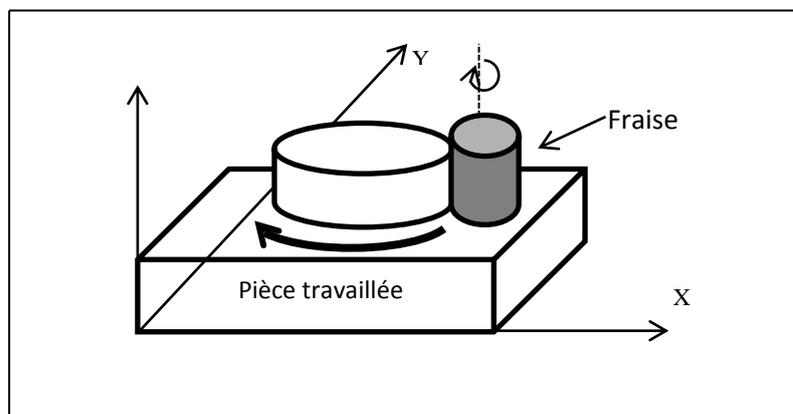
**Fig.1-12. Commande numérique de contournage.[5]**
