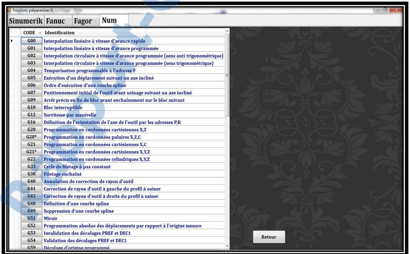
Fig 3-15. Fonctions préparatoires G de la commande NUM.
