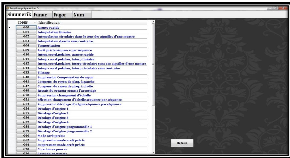
**Fig 3-13. Fonctions préparatoires G de la commande Sinumerik.**
