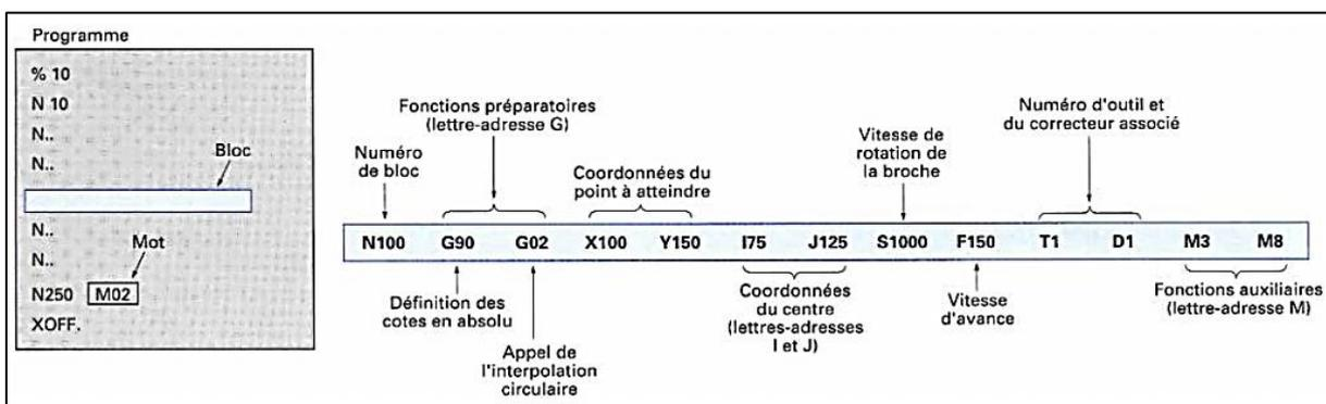
Fig.1-13. Structure d'un bloc de programme d'usinage.[3]
