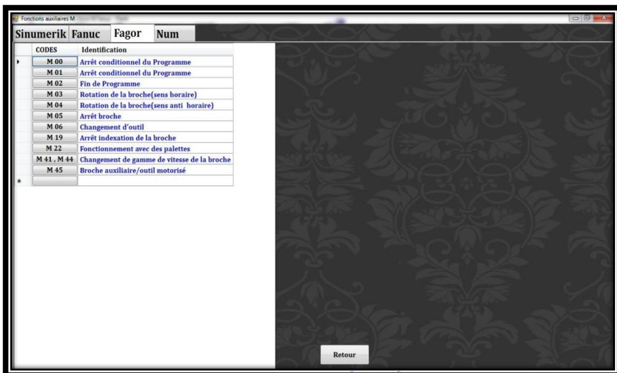
Fig 3-19. Fonctions auxiliaires M de la commande Fagor.
