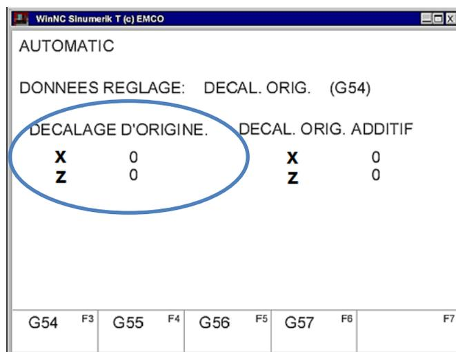
Fig.2-9. Masque d'entrée pour décalage d'origine G54.[4]
