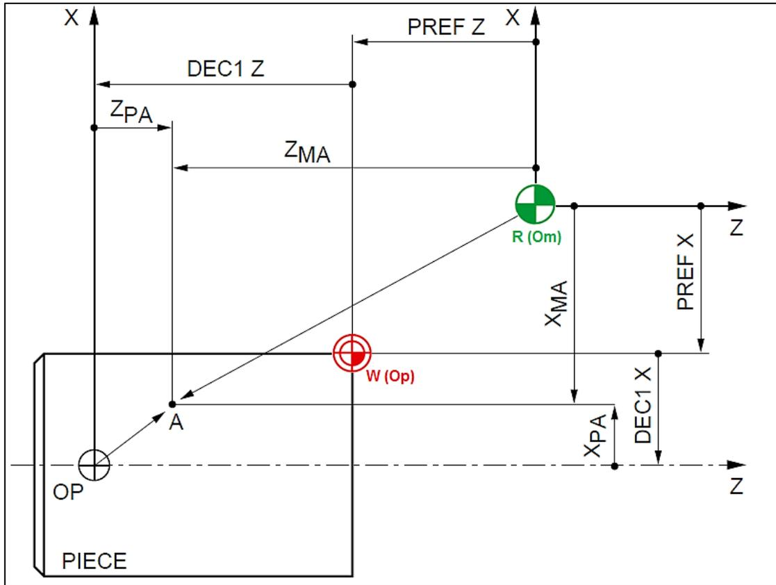
Fig.2-6. Représentation des cotes programmes et cotes mesures[6]
