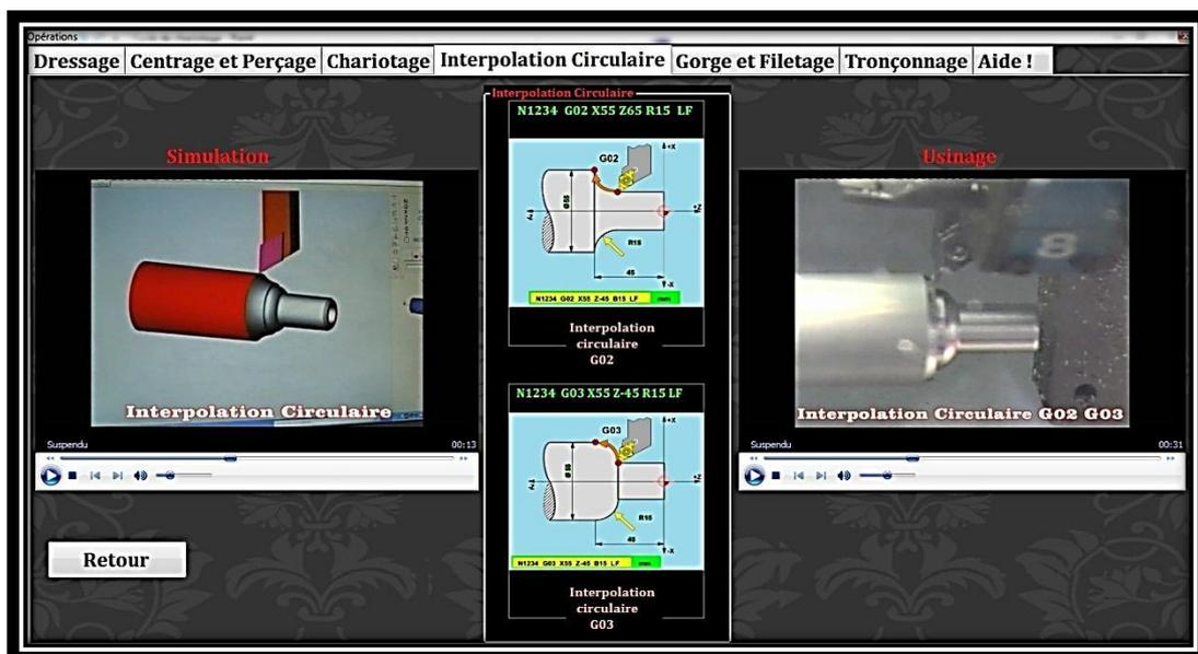
Fig 3-9. Interpolation circulaire G02 et G03.
