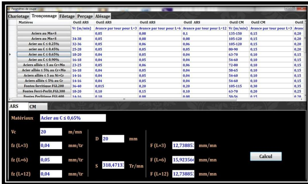
Fig 3-11. Calcul des paramètres de coupe en tronçonnage.
