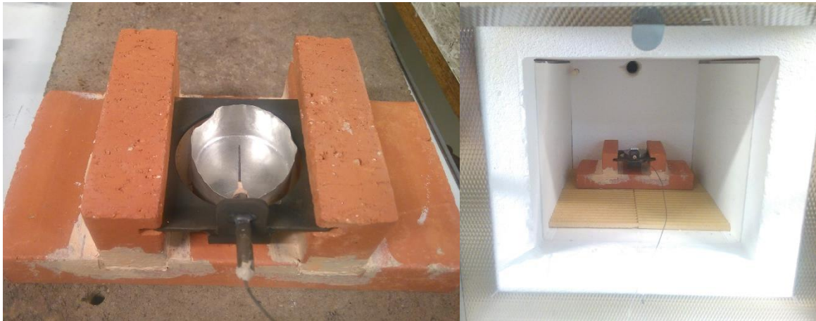
Figure 33. À gauche : structure en brique réfractaire dans laquelle vient s'insérer le support en acier inoxydable, équipé d'un thermocouple et accueillant le creuset en Pt. À droite : positionnement de l'ensemble du dispositif dans le four à moufle.
