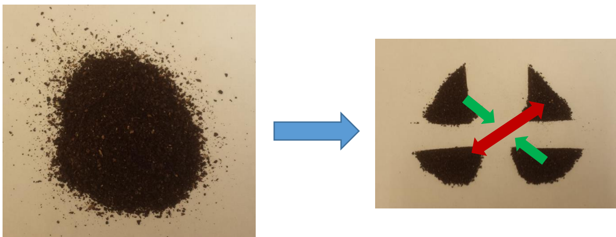
Figure D.1. Illustration du principe de la méthode de quartage, présenté ici pour un broyat de marc de raisin
