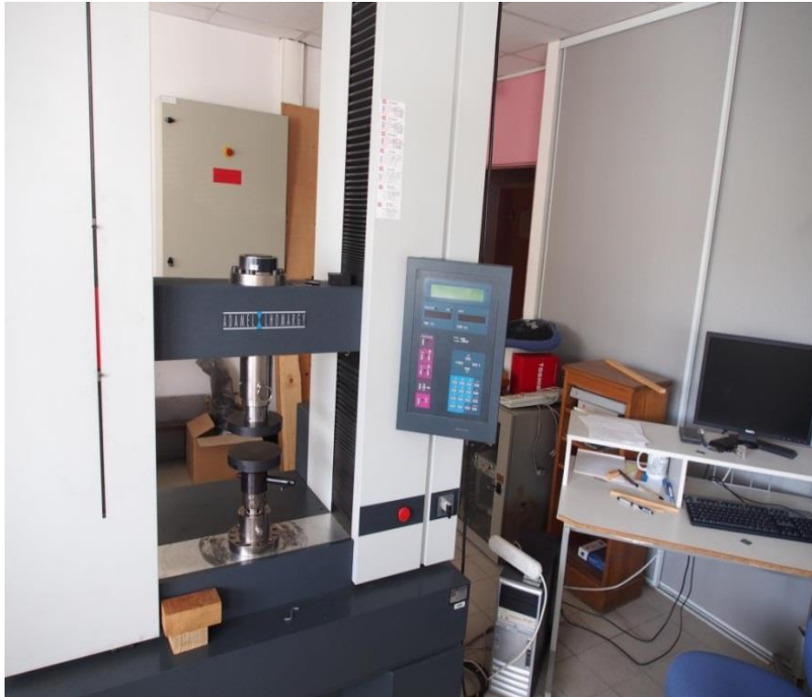
Figure 25. Presse Adamel Lhomargy utilisée pour la mise sous pression de la biomasse à l'intérieur du moule.
