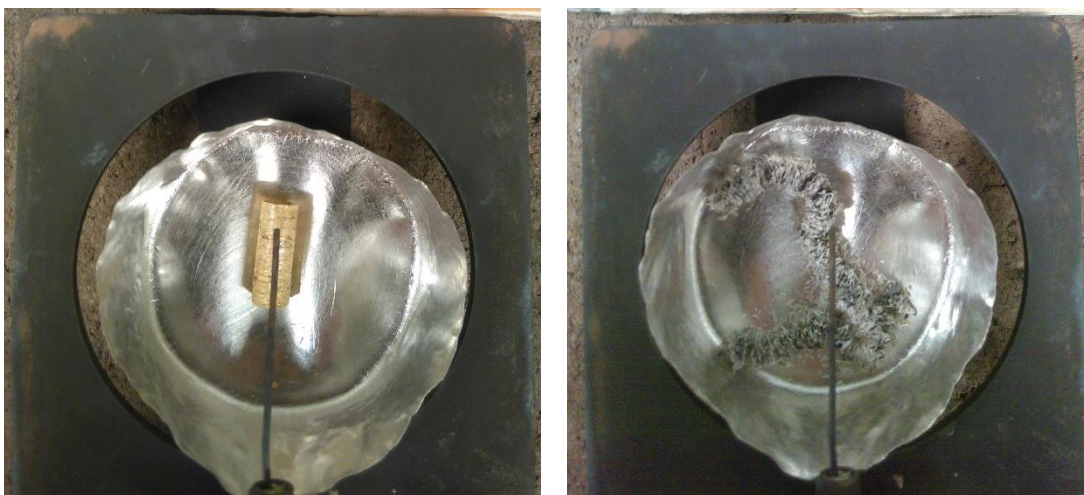
Figure 57. Granulé de balle de riz, avant et après un essai de combustion à 550 °C
