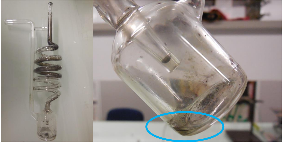
Figure 30. Serpentin de refroidissement après une expérimentation de combustion.
