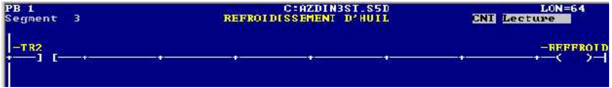
Figure 49 : le programme de refroidissement sur STEP 5
