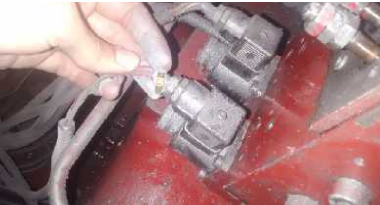
Figure 21 : Y3, Y4 et Y5 relais de commande du distributeur
