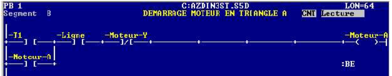
Figure 57 : alimentation du moteur en montage triangle A
