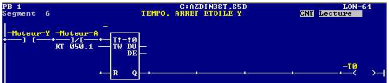
Figure 55 : temporisateur arrêt du montage étoile
