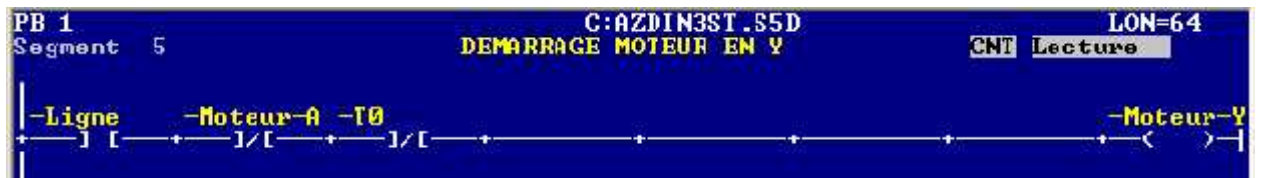
Figure 54 : démarrage en étoile Y
