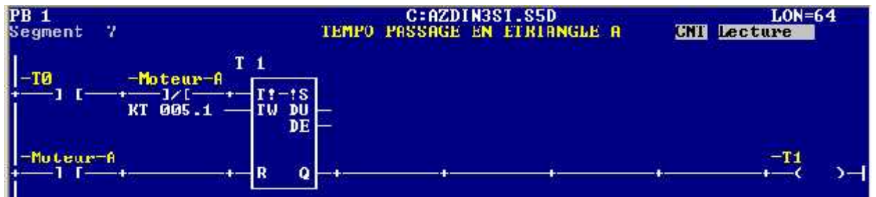
Figure 56 : temporisateur passage en triangle A
