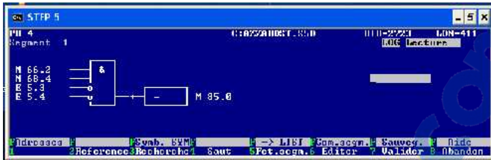
Figure 82 : schéma en LOGIGRAMME
