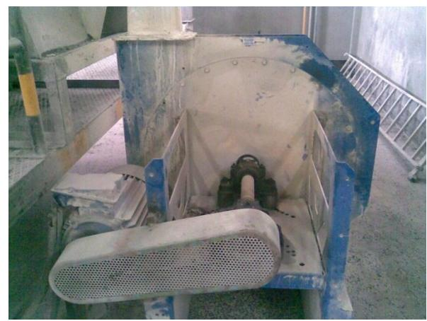
**Figure 24.** Adaptation de la solution d'accouplement au moteur de l'aspirateur.
