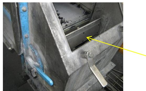
**Figure 18.** Clapet de contrôle de hauteur d'un refroidisseur type.
